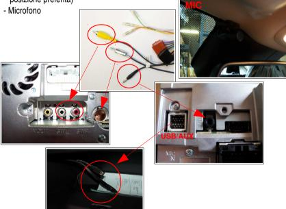
8. Collegare gli spinotti ISO dell'autoradio al cablaggio e le boccole per i servizi; sul filo è indicata la funzione. Nel caso in cui un servizio non sia richiesto non effettuare il collegamento oppure disattivare il servizio dalla radio. Collegare i rimanenti connettori del cablaggio del kit ai connettori dell'automobile
