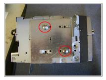
Nota: per avere la possibilità di una migliore centratura verticale dell'autoradio si consiglia di montare due viti in diagonale come in figura
