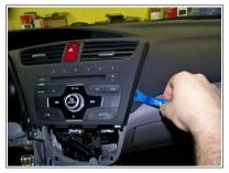
4. Scollegare i connettori, rimuovere e conservare le viti di fissaggio delle bocchette d'aria e rimuovere il pulsante 4 frecce
