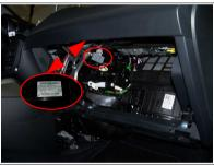
2. Rimuovere la sezione dei comandi del climatizzatore e staccare il connettore
