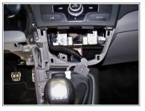
3. Svitare le viti di fissaggio e rimuovere il modulo radio
