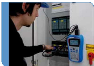
Magnetyczny uchwyt ułatwiający obsługę w czasie pomiaru
