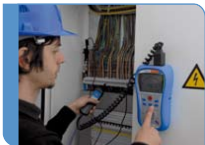
Magnetyczny uchwyt ułatwiający obsługę w czasie pomiaru
