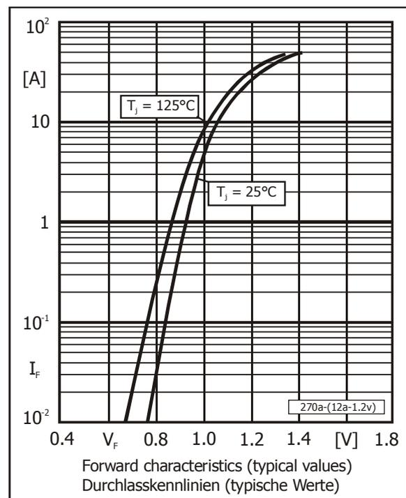
1 Valid, if the temperature of the case is kept to  $T_C = 120^\circ\text{C}$  – Gültig, wenn die Gehäusetemperatur auf  $T_C = 120^\circ\text{C}$  gehalten wird
