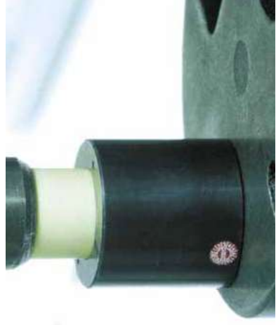
Obraz 12: Łożyško powinno być wciśnięte w gniazdo za pomocą prasy
