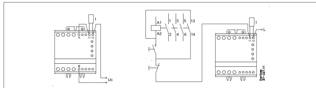
**Démarrage progressif commandé par la tension principale**
