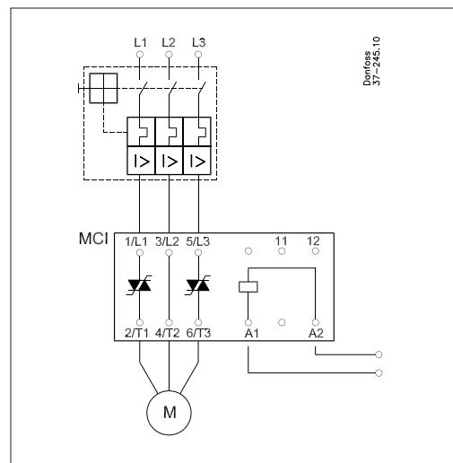
**Combinaison de l'inversion et des démarrage et arrêt progressifs**
