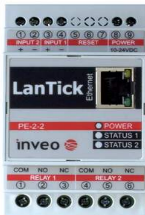
Widok diod sygnalizacyjnych
