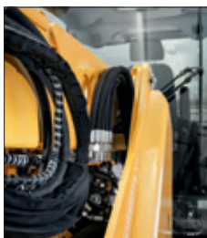
Helagaine HEGWS: optymalna ochrona przewodów hydraulicznych.
