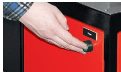
Przycisk sterujący gilotyną do cięcia szyn.
