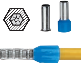
Forma zaprasowania końcówki na przewodzie.
