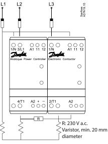
Max. load at: 400 V ACI 30-1 20.7 kW ACI 50-1 34.5 kW
