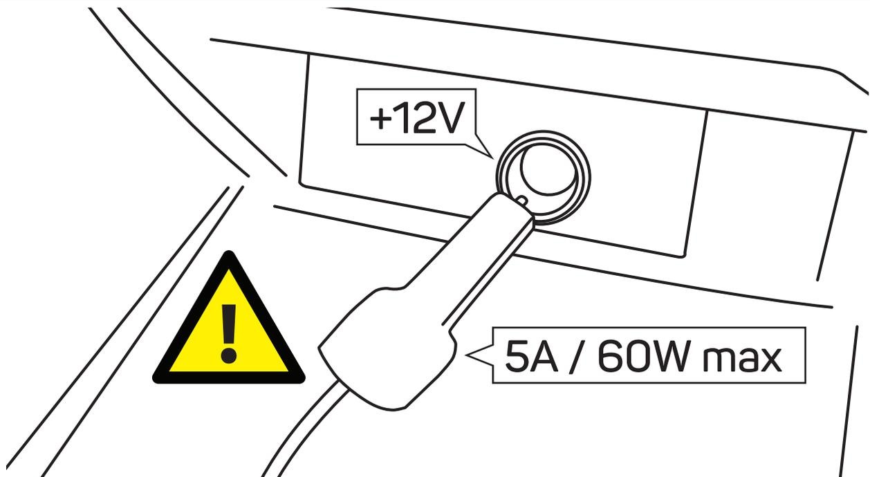
**ACHTUNG!** Nach der Installation dürfen keine Geräte/Verbraucher mit mehr als **5A / 60W** an der +12V Buchse betrieben werden, da sonst die Gefahr einer Überspannung besteht!
