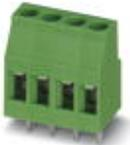
Leiterplattenklemme, Nennstrom: 24 A, Nennspannung: 400 V, Rastermaß: 5,08 mm, Polzahl: 8, Anschlussart: Schraubanschluss mit Zughülse, Montage: Wellenlöten, Anschlussrichtung Leiter/Platine: 0 °, Farbe: grün. Der Artikel ist zu unterschiedlichen Polzahlen anreihbar!
