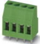
Leiterplattenklemme, Nennstrom: 24 A, Nennspannung: 400 V, Rastermaß: 5,08 mm, Polzahl: 9, Anschlussart: Schraubanschluss mit Zughülse, Montage: Wellenlöten, Anschlussrichtung Leiter/Platine: 0 °, Farbe: grün. Der Artikel ist zu unterschiedlichen Polzahlen anreihbar!
