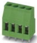
Leiterplattenklemme, Nennstrom: 24 A, Nennspannung: 400 V, Rastermaß: 5,08 mm, Polzahl: 4, Anschlussart: Schraubanschluss mit Zughülse, Montage: Wellenlöten, Anschlussrichtung Leiter/Platine: 0 °, Farbe: grün. Der Artikel ist zu unterschiedlichen Polzahlen anreichbar!
